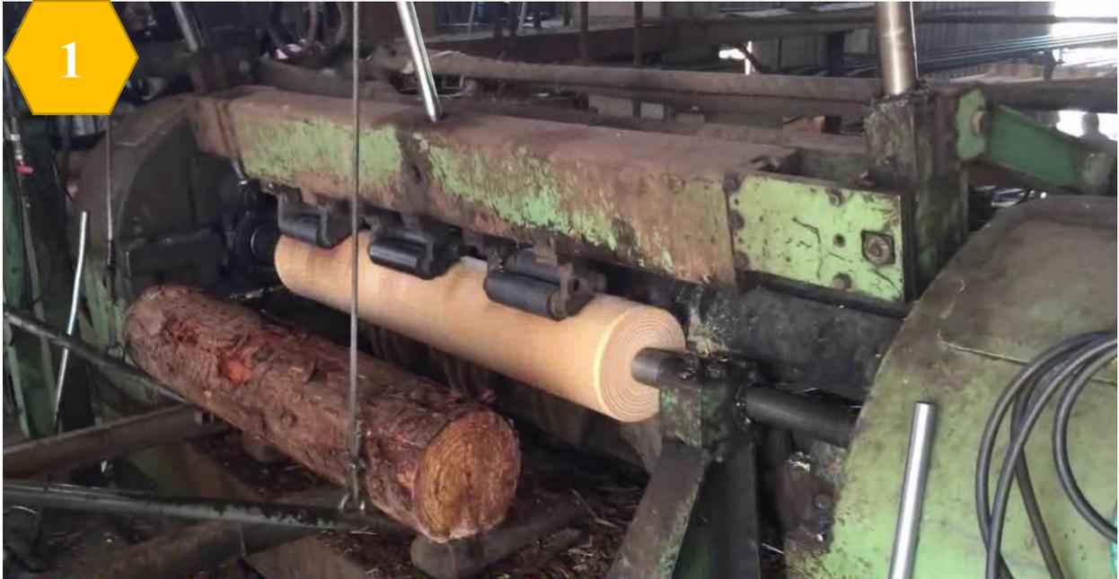
2. **Lạng Veneer:** Gỗ sau khi được bóc vỏ đưa vào máy lạng veneer theo kích thước 600mm x 1200mm hoặc 65cm x 1350mm hoặc theo kích thước yêu cầu từ phía khách hàng mà Công Ty Somma sẽ lạng nguyên liệu sau cho tối ưu giá thành sản phẩm cũng như đạt chất lượng tốt nhất.
