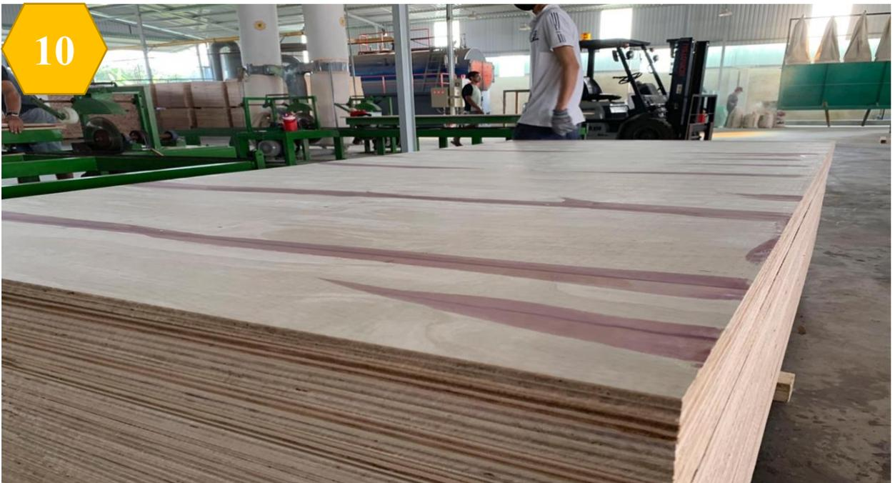
11. **Hệ Thống chà Nhám:** KIỆN ván sau khi được cắt cạnh sẽ chuyển qua chà nhám, công đoạn chà máy được Công ty Somma chà nhám 2-3 lần. Chà nhám lần 1 sau đó xử lý những điểm cho hoàn thiện trên bề mặt ván, chà nhám lần 2 tiếp tục xử lý tiếp những điểm còn chưa hoàn thiện và xử lý 4 cạnh của ván bằng keo vào bột chống kháng nước.
