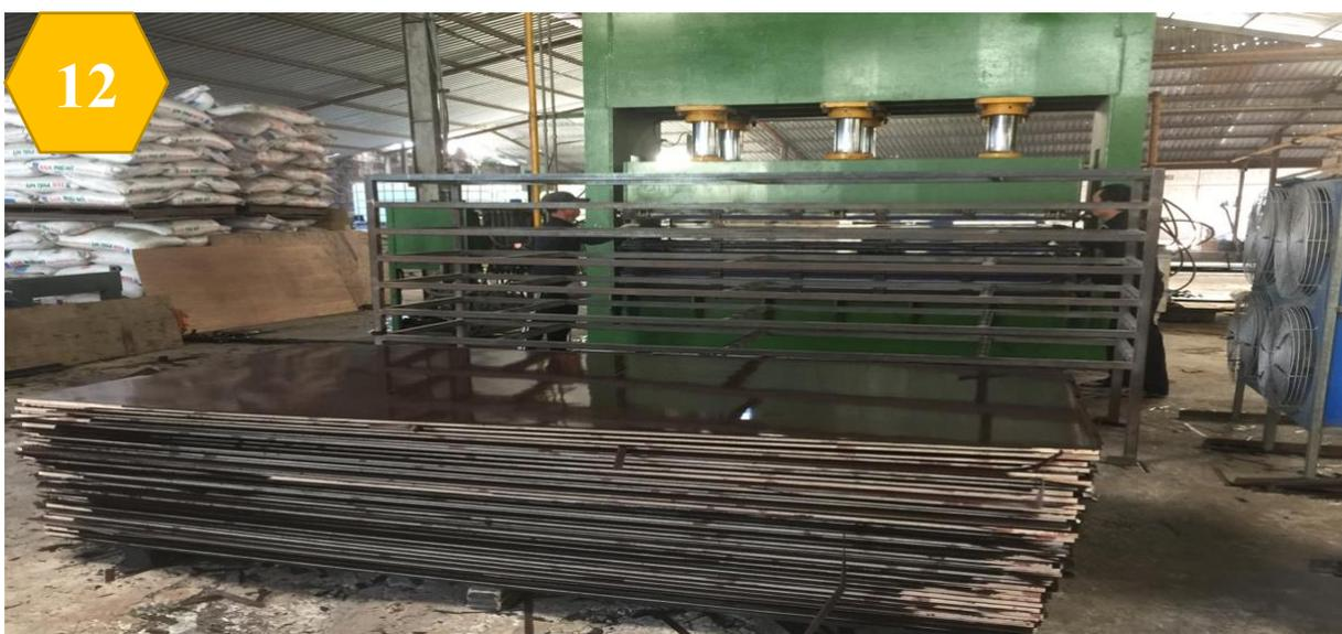
13. **Lăn Keo Chống Nước & Đóng Kiện Ván:** Sau khi ván được ép phim lên 2 bề mặt, ván thành phẩm sẽ được xếp lên máy đóng kiện, tại đây ván được lăn keo chống thấm nước lên 4 cạnh ván nhằm đảm bảo chống thấm nước khi đưa ra công trình sử dụng. Sau công đoạn lăn keo cạnh ván sẽ là công đoạn đóng đai thành từng kiện cho từng quy cách. Sau đó ván được lưu trữ vào kho hoặc vận chuyển ra công trình sử dụng.
